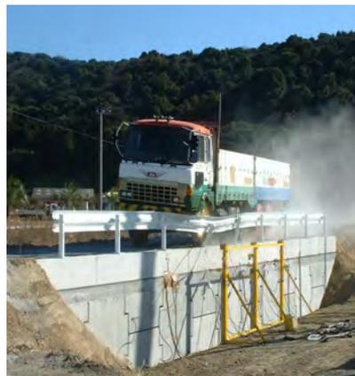
補強土壁擁壁工天端設置時の実車衝突
