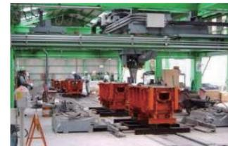
FMSライン (Flexible Manufacturing System) 作業フロアがフラットで安全 専用のパレットが不要 条件が整えば、何でもライン投入可能！
